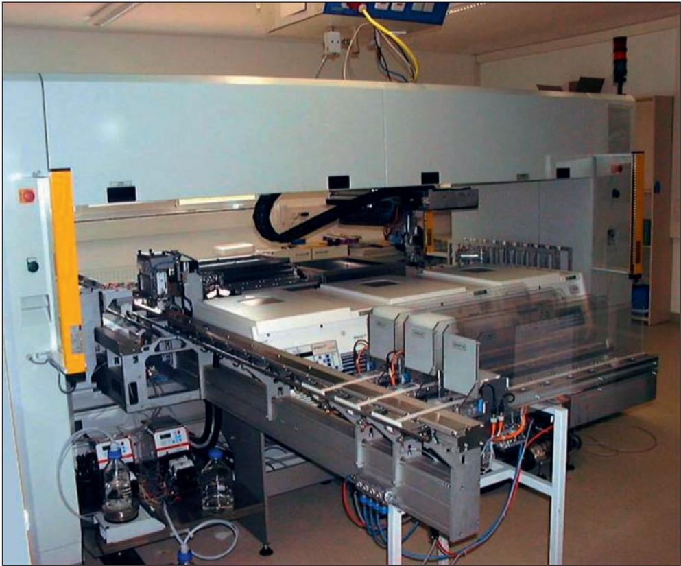
Abb. 4 HEDIS Hochdurchsatz-DNA/RNA-Isolierungsroboter der Fa. Agrobiogen GmbH zur DNA/RNA-Isolation aus Ohrgewebeproben mit einer Kapazität von bis zu 20000 Isolation pro 24 Stunden
