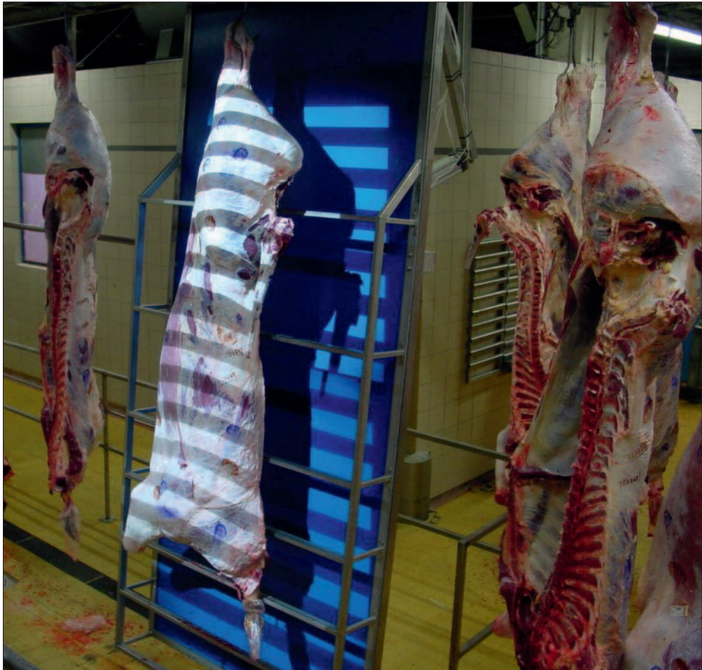
Abb. 1 Videobild einer Rinderhälfte am Schlachtband. Die Krümmung der Lichtstreifen enthält Informationen zur Ausbildung wertvoller Teilstücke und Muskelpartien im Schlachtkörper. Zusätzlich ist das Gewicht der Hälfte bekannt (Bild: E+V Technology GmbH, 16515 Oranienburg, Deutschland).
