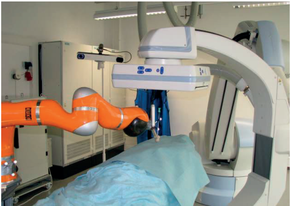
Abb. 7 Kombination aus robotisch geführtem C-Bogen und robotisch geführtem Punktionsbesteck (PENZKOFER et al. 2010)
