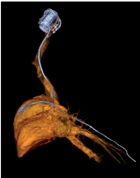
Abb. 2 Implantierter pulmonalarterieller Drucksensor (AME / RAD, RWTH Aachen University)
