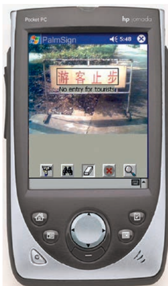
Abb. 12 Road-Sign-Translator : Übersetzung von Straßenschildern
