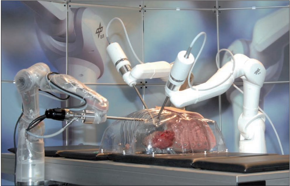
Abb. 17 MIRO-System des DLR, ferngesteuerte Roboterchirurgie durch kleine Einstiche im Körper
