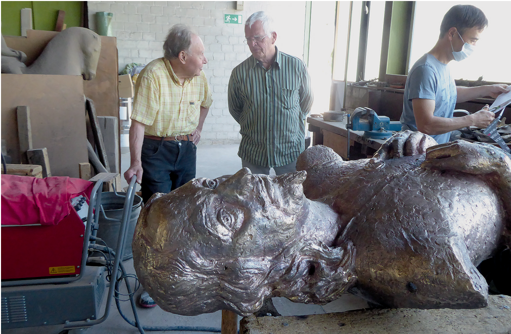
Abb. 42: Rohguss der Büste in der Bildgießerei Barth (Rinteln)
