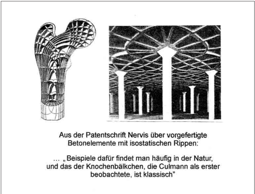
Abb. 7 Flächen gleicher Spannung im Oberschenkel (Mensch) sowie P. C. NERVIS isostatische Rippen und kennzeichnendes Zitat (nach KUMMER 1965 sowie NERVI und BARTOLI 1950)
