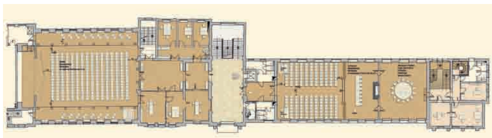
Der Grundriss zeigt das erste Obergeschoss mit einer möglichen zukünftigen Bestuhlungsvariante des Festsaals, des Vortragssaals und des Sitzungsraumes des Präsidiums.
